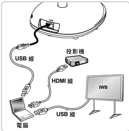
⚠ 当USB连接上电脑，电源即启动。LED显示灯亮红灯，表示显示影像中。
